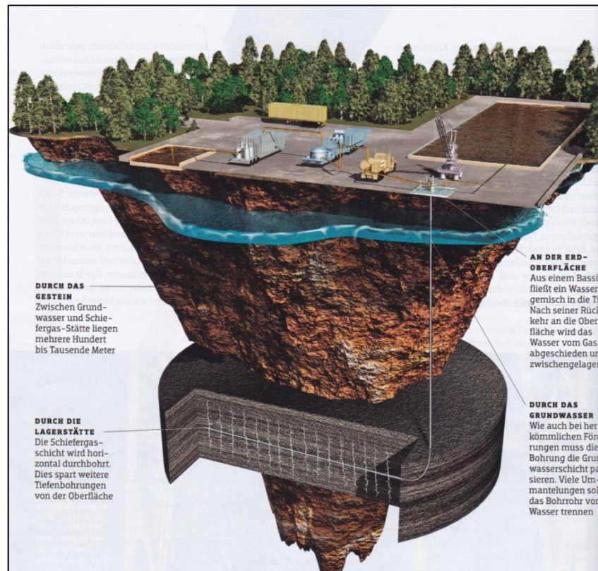
Abb. 7 Schematisches Raumbild zur Erschließungslage eines „Schiefergas-Muttergesteins“ unterhalb des Grundwasser-Niveaus. Aus P.M. 11/22, S. 20 – 31, Hamburg (Gruner + Jahr)
