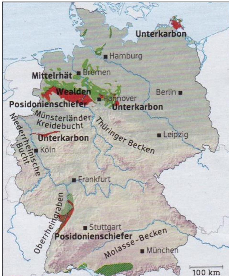
Abb. 8 Potenziell höffige Gebiete in Deutschland für Schiefergas (rot) und Schieferöl (grün), die ggf. über den Einsatz der Fracking-Technologie zu gewinnen sind.
